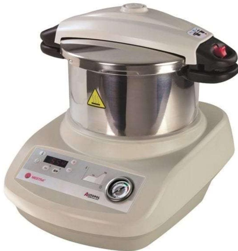
Olla polimerizadora de gran capacidad de cuba (hasta 6 litros), que permite acomodar en su interior una considerable cantidad de elementos para polimerizar. Mediante un control electrónico se pueden regular y mantener hasta 5 temperaturas definidas por el usuario. Datos técnicos: Tensión: 230 V Temperatura máxima: 100°C Presión de trabajo: 2 bares Potencia calentamiento: 600 W Volumen de la cuba: 6 litros. Tamaño: 350x360x400mm (alto, ancho, fondo). Peso: 5,5 kg.
