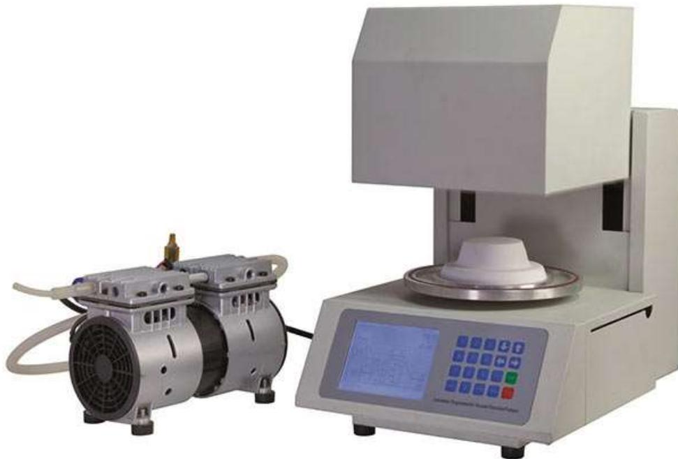
Totalmente automático, compatible con los diferentes tipos de porcelana presentes en el mercado. Incluye una bomba de alto vacío.
