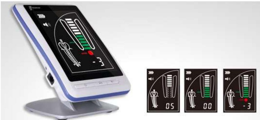
El localizador de ápices de Woodpex III "Pro" tiene una tecnología multi frecuencial para la localización y detección apical. Incluye una calibración automática. También permite medir la longitud de la endodancia sin el secado del canal. Ofrece una pantalla de LCD con posibilidad de inclinación para máxima claridad de la imagen, indica con claridad la trayectoria de la lima con diferentes colores. Los accesorios pueden ser esterilizados. Dispone de una batería recargable de larga duración.
